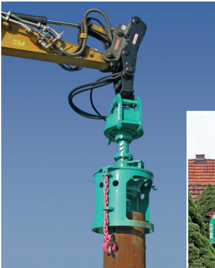
Bilder: Bohrantrieb BA 2200 mit Rohrdrehvorrichtung RDV 400-660 angebaut über eine Schnellwechseleinrichtung (oben), Bohrantrieb BA 2200 mit Endlosschnecke (rechts)
